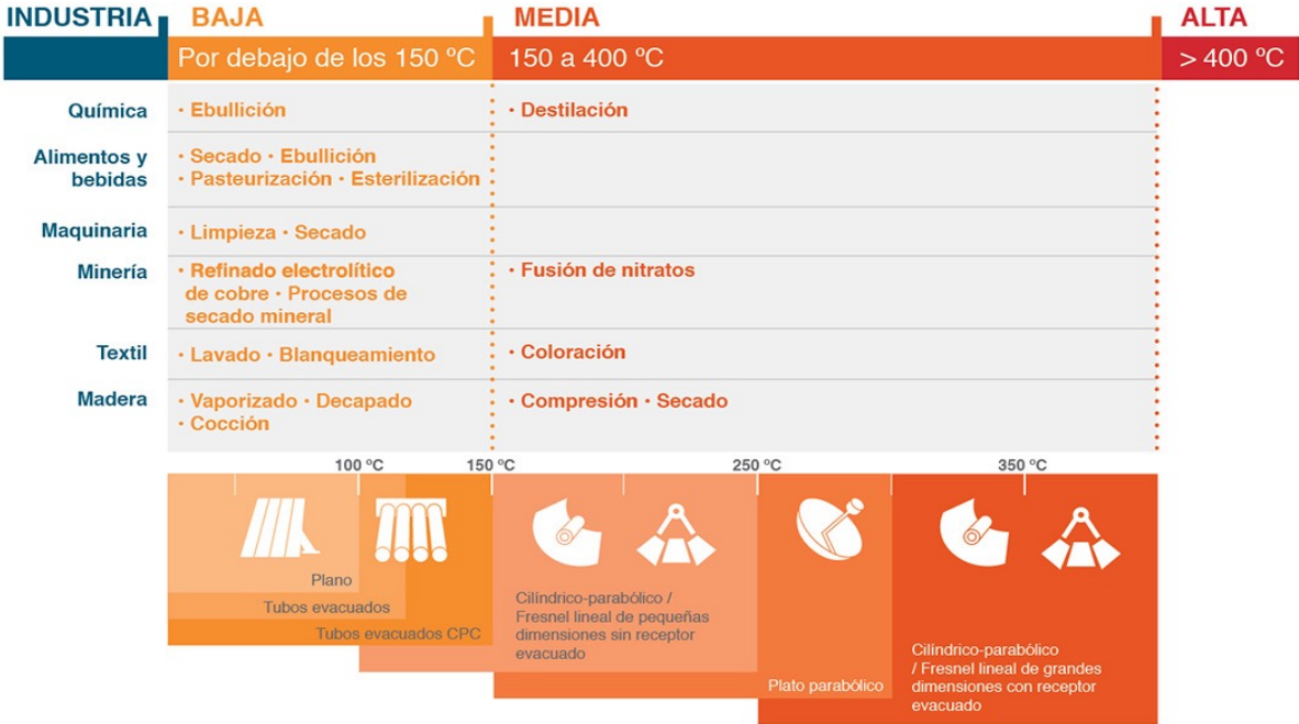
Figura 4. Segmentos del mercado de colectores solares aplicados en la industria, fuente: Solar Payback
