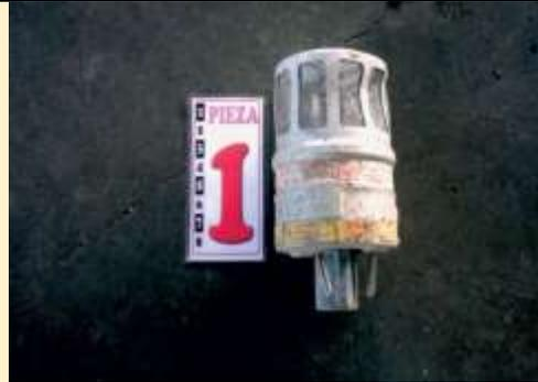
Figura 16 Detector de humo equipado con fuente de Ra-226.
