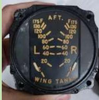
Figura 14 Medidor de combustible con pintura luminosa (Radio-226) utilizado en tanques de algunos aviones.
