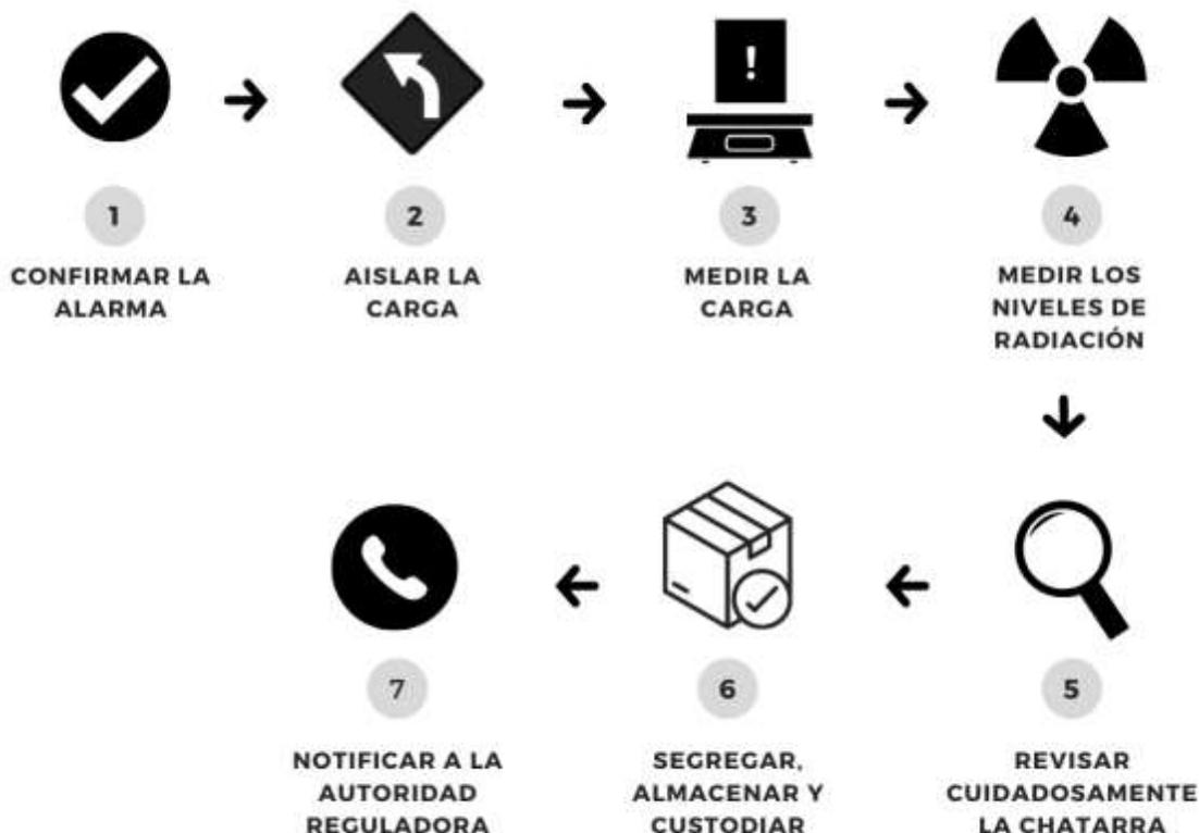
Ilustración 4: Pasos a seguir al momento de identificar material radiactivo en entrada de la instalación.
