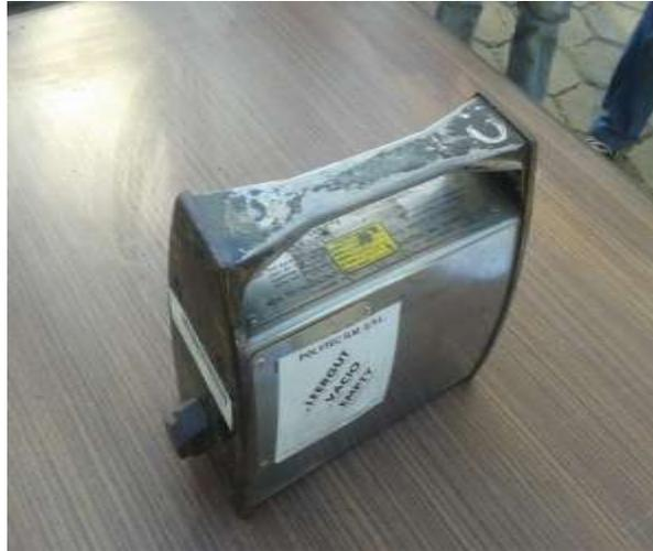
Ilustración 3: Equipo de gammagrafía usado en la industria.
