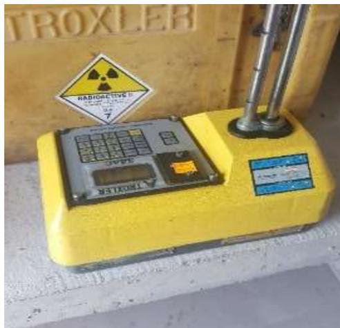
Ilustración 2: Densímetro nuclear usado en la industria.
