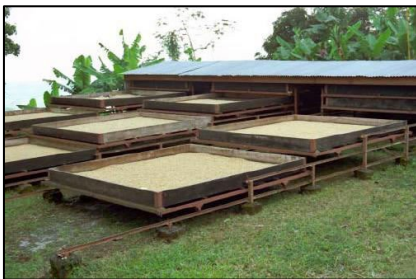
Figura # 8 - Secador solar de café en carros, figura tomada de cenicafe.org .
