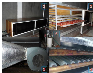
Figura # 6 - Ejemplo de un prototipo inicial de un deshidratador geotérmico; 1) Túnel de secado, 2) Bandejas con producto (tomate y manzana), 3) Soplador, 4) Serpentin calefactor, 5) Calentador de agua para simular el flujo geotérmico (Grupo iiDEA, UNAM 15 )
