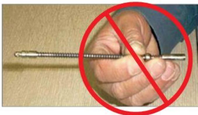
Figura 8: Fuente muy peligrosa de cámara de radiografía industrial (nunca debe recogerse)
