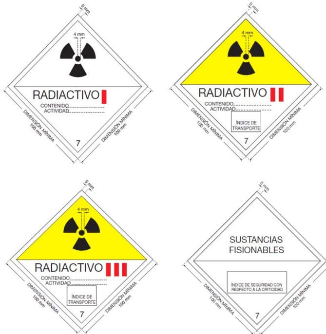
Figura 6: Etiquetas de bultos con fuentes potencialmente peligrosas
